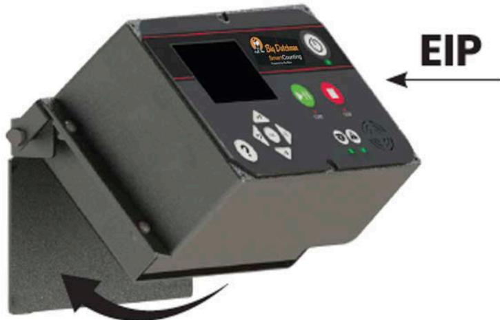
4. **Stecken Sie die Kamera und das Internetkabel** in die dafür vorgesehenen Buchsen der EIP-Einheit. Schließen Sie das Stromkabel an eine Steckdose mit Schutzerdung an.
